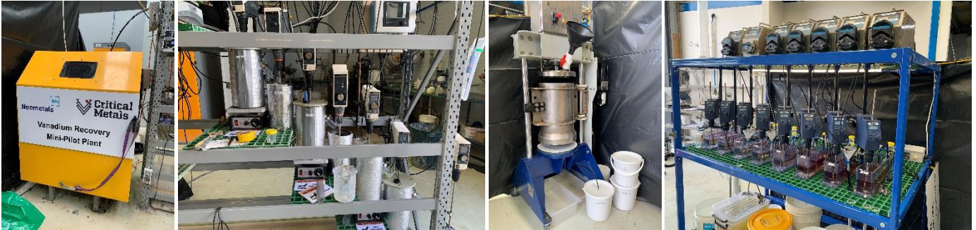
Abb. 1: Ausgewählte Bilder der Mini-Pilotanlage, einschließlich (von links nach rechts) der Stabmühle, des integrierten Laugungs- und Mahlkreislauf, des Druckfilters und des Lösemittelextraktionskreislaufs
